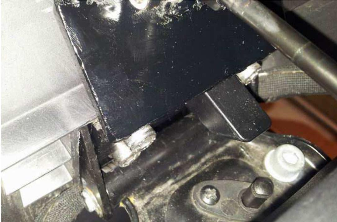
Stretti bene i bulloni e con la sella ripristinata posizioniamo il coperchio batteria e fissiamolo con la sua cinghia originale, la quale ovviamente resterà all'esterno del pistone a gas. Infine, fissiamo l'asola esterna del pistone ai dadi della piastra mediante un bullone 6x30 che andremo a stringere con dado e controdado in modo che non si possa svitare mai. E adesso buon divertimento con la vostra nuova sella che si alzerà da sola!
